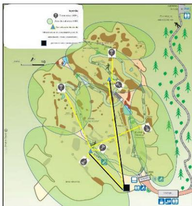
Figura 10. Área de cobertura y centralización de ruta de Comunicación (M.D Soluciones en Comunicación)
