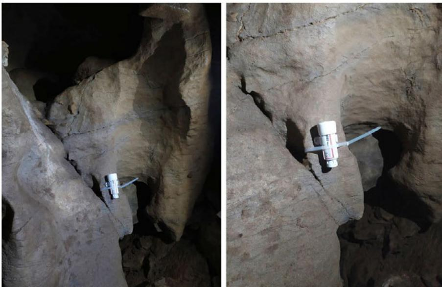
Figura 3. Medidor ambiental HOBO instalado en la galería decorada de Aitzbitarte III para la obtención de datos de humedad y temperatura
