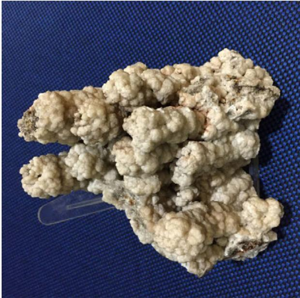
*Figura 10. Estalactitas botroidales de smithsonita con vanadinita en el núcleo (escala 1:4). Muestra extraída de una escombrera de la mina Garandina. (Foto Francisco J. Fdez. Amo)*
